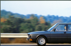
BMW 524td 1600 cm³, 125 kW (170 PS), 5-Gang-Schalt- getriebe, 170 km/h Höchstgeschwindigkeit, 10,4 Liter/100 km Verbrauch (90 km/h) BMW Group, München/Ford
